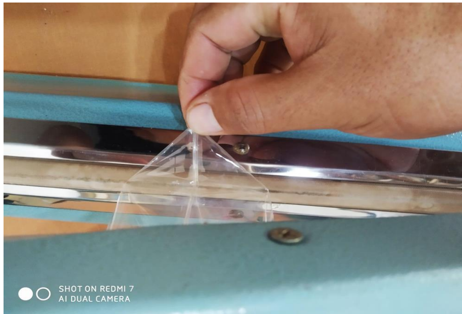
Gambar 2 Pengelasan Ujung Plastik
